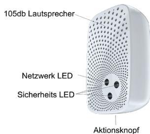
Befindet sich die Sirene im Normalmodus, ist die LED aus. Sobald ein Alarm von einem assoziierten Z-Wave Gerät ausgelöst wird, wechselt die Sirene in den Alarm Modus. Die Lautstärke und Art der Sirene ist dabei von der Konfiguration abhängig. Durch den Taster am
