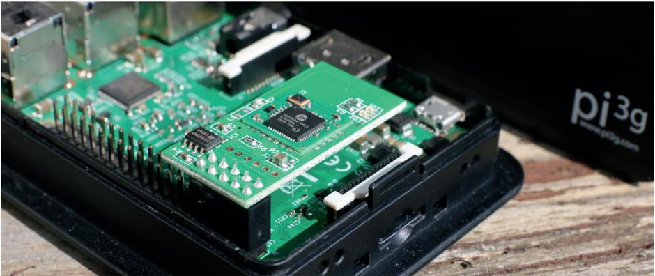
Der Chipsatz des in den Raspberry Pi integrierten WLAN-Adapters funktioniert unter Raspbian ohne die Installation weiterer Treiber. Die für das bereits vormontierte RaZberry-Modul notwendigen Einstellungen im Betriebssystem des Raspberry Pi 3 sind bereits erfolgt.
